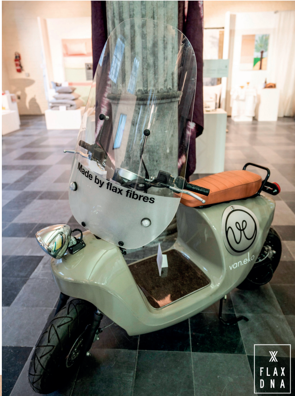
Figuur 2: scooter uit vlasvezel en biogebaseerd hars
